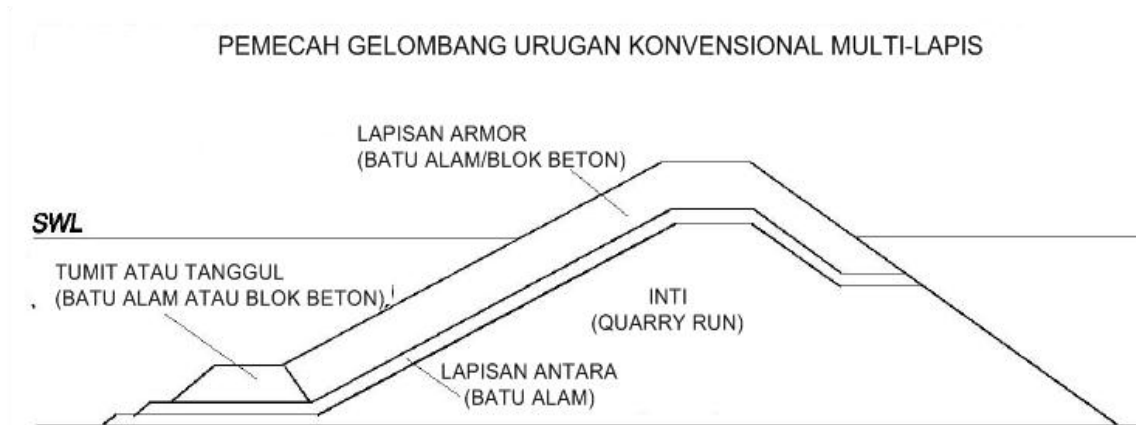
Gambar II.F.25 Pemecah gelombang urugan multi-lapis konvensional
