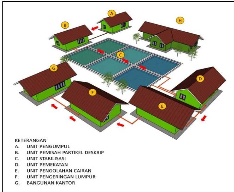
Gambar 42. Ilustrasi IPLT
