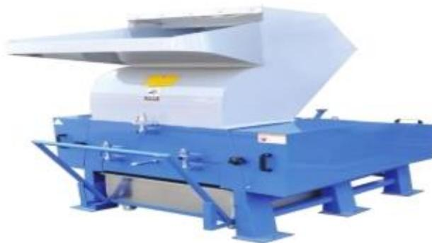
Gambar 16. Mesin pencacah Plastik
