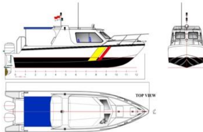
Gambar 26. Contoh Spesifikasi Dimensi Eksterior Speedboat
