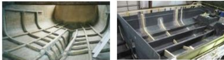
Gambar 14. Konstruksi Lambung Speedboat
