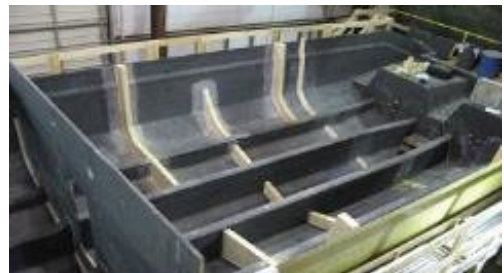
Gambar 11. Konstruksi Lambung Speedboat PSDKP
