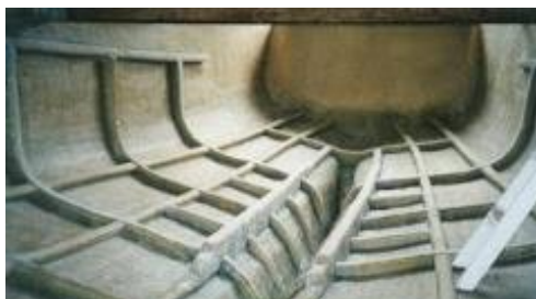
Gambar 11. Konstruksi Lambung Speedboat PSDKP
